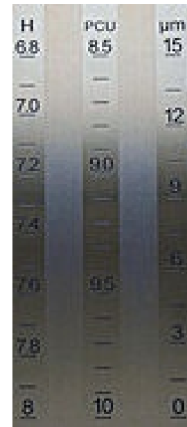
Grindometer Bestimmung der Partikelgröße
